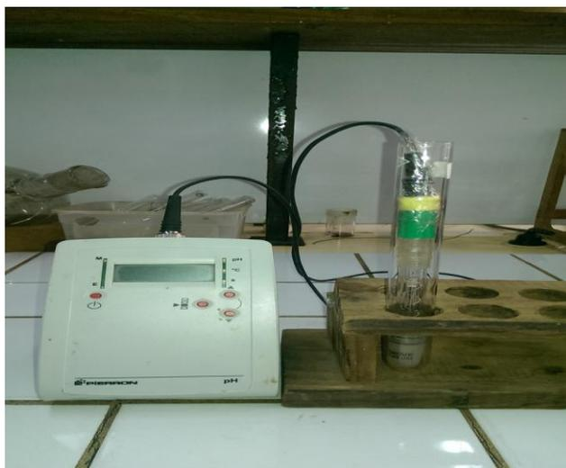
**Figure 2 : pH-mètre utilisé pour mesurer l'acidité des contenus gastriques.**
