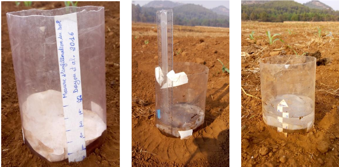
Photo 1. Dispositif de mesure d'infiltration du sol
