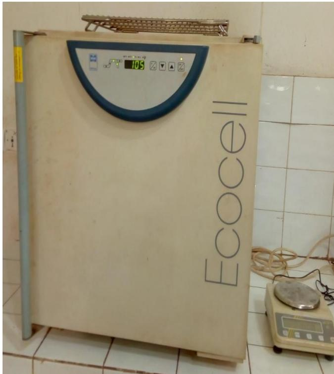
**Figure 6 :** Photo de l'étuve et de la balance de précision
