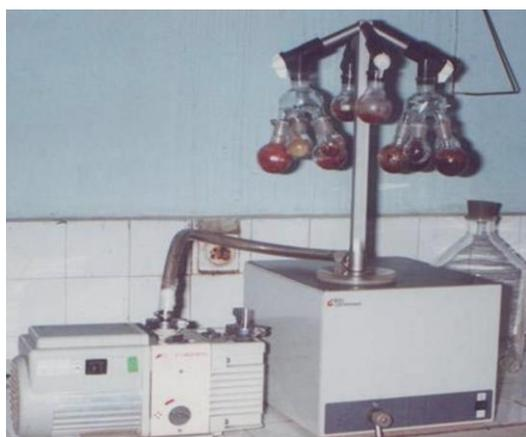
**Figure 15 :** Photo du lyophilisateur pour sécher nos fractions aqueuses.
