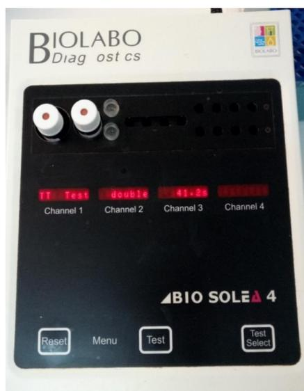
Figure 16 : Photo du coagulomètre
