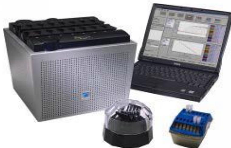
Figure 2 : Dispositif complet utilisé pour l'amplification de ARN/ADN : Thermocycleur = SmartCycler® (Stratagème) ; Ordinateur portable ; mini centrifugeuse pour tube PCR ; portoir de tube PCR.
