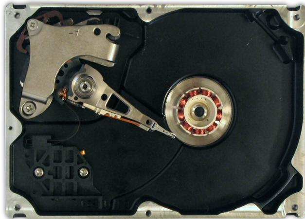
FIG. 22 – Vue intérieur d'un disque dur
