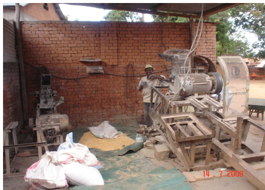
Photo n°1 : Provenderie locale, à gauche broyage d'os et de coquillages, au centre les composants, à droite le broyeur, ( Source : Nary)
