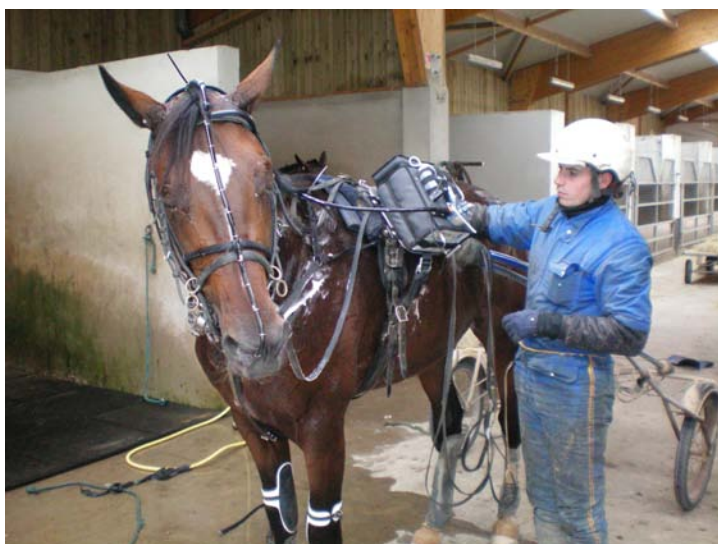
Image 13 : Fixation du DRS sur un trotteur (MICHEL A)
