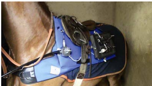
Image 15 : Tapis de selle adapté à la fixation du DRS (Optomed)
