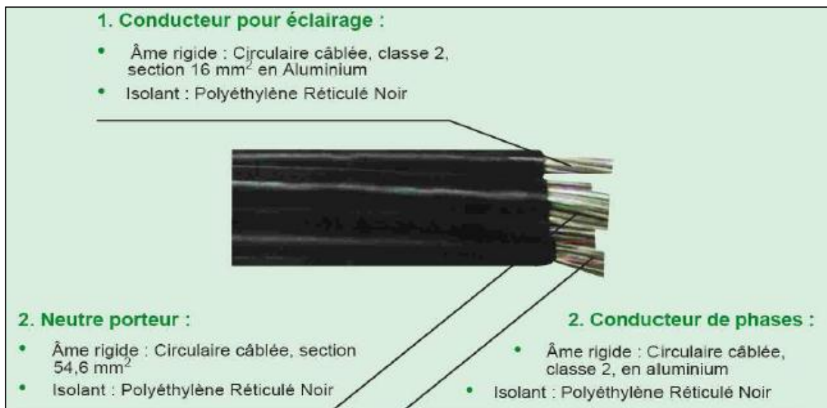
Figure 6 : Câble de distribution
