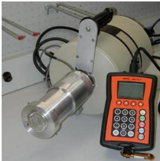
Figure 5 : Exemple d'instrument portable digi-DART de ORTEC
