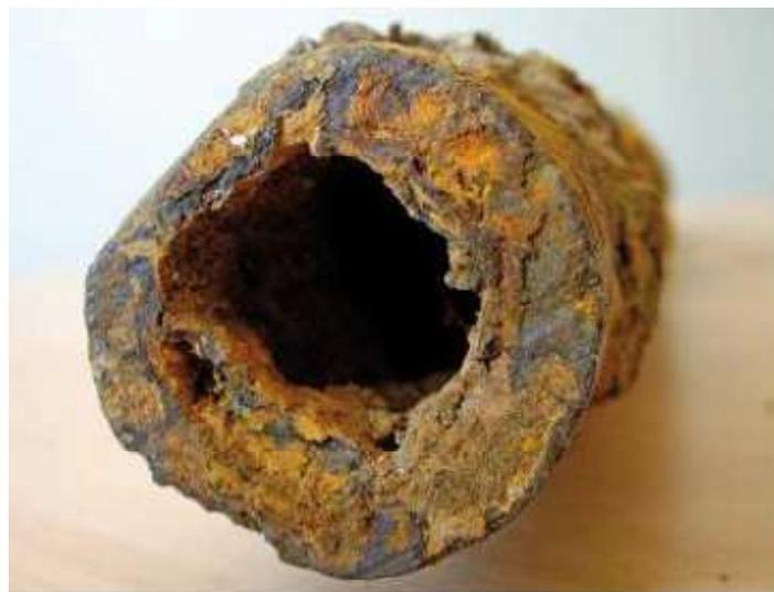
**Figure 1.3** Vieillissement des canalisations. [1]
