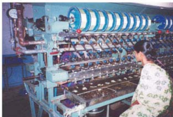
3.2.3 : machine pour filer les cocons Siddalaghata, Octobre 2002, C. Didelon
