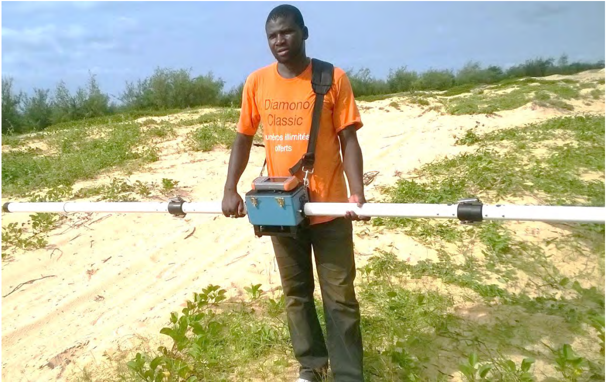
Photo 4 : Acquisition des données électromagnétiques sur la dune littorale avec l'EM 31 type GEONICS
