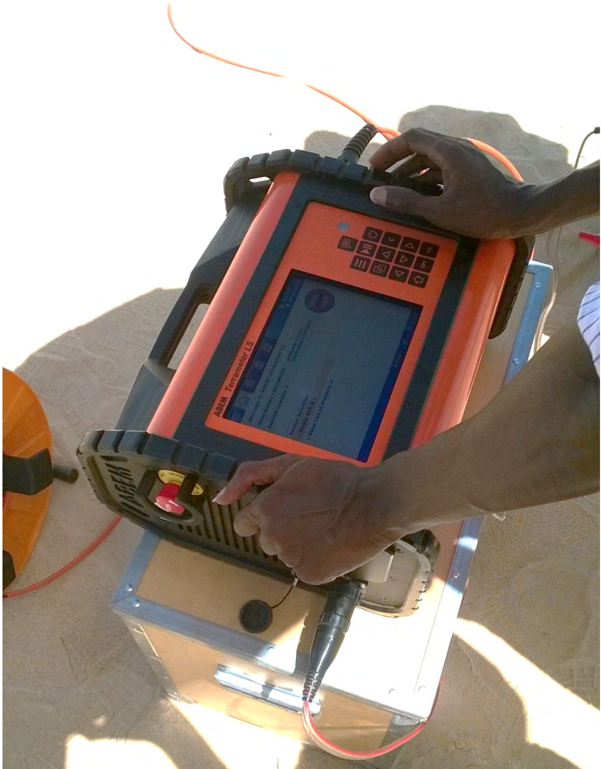
Photo 3 : Acquisition des données avec le Resistivimètre type ABEM doté d'un écran LCD
