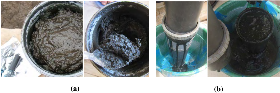
Figure 7.3 : Echantillons de boues après filtration : boue pâteuse collectée avec une cuillère (a) et boue liquide collectée avec un pot après homogénéisation (b)
