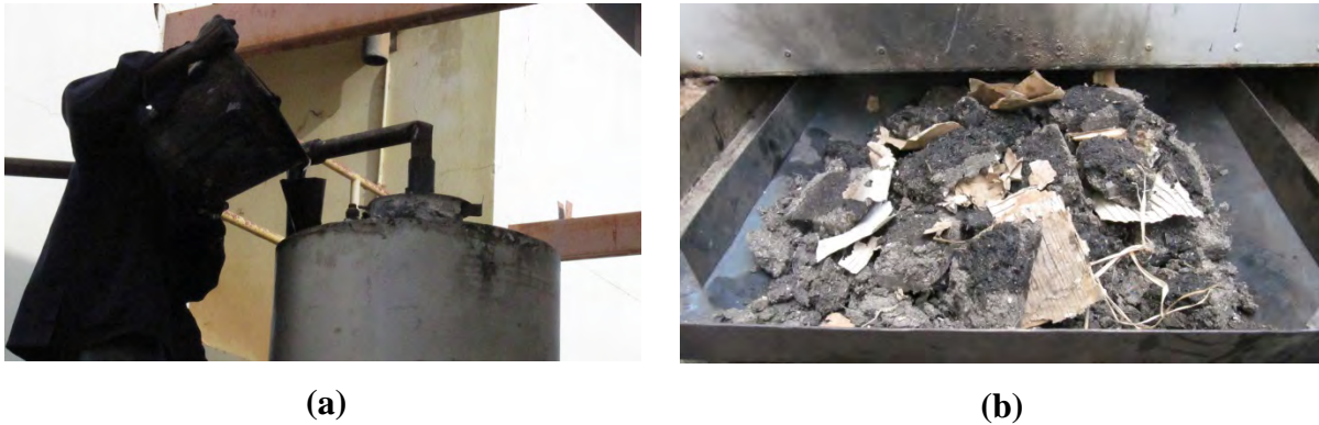
Figure 5.4: Remplissage du réservoir d'huile (a) et amorce de la combustion (b)
