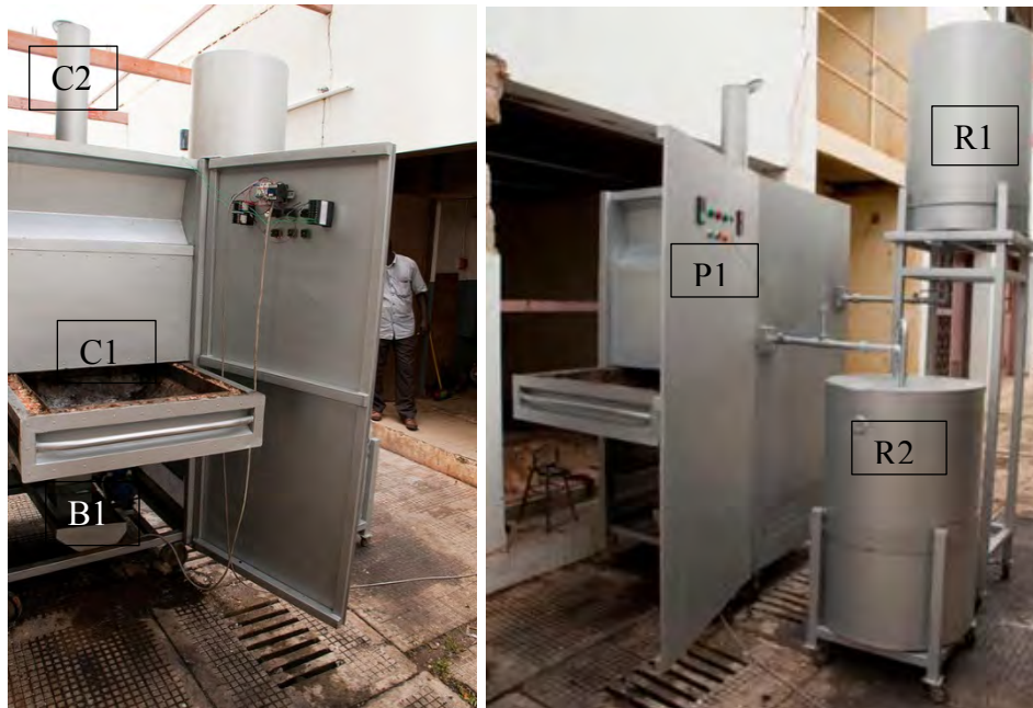
Figure 5.2: Vue réelle de four pilote de combustion des biosolides
