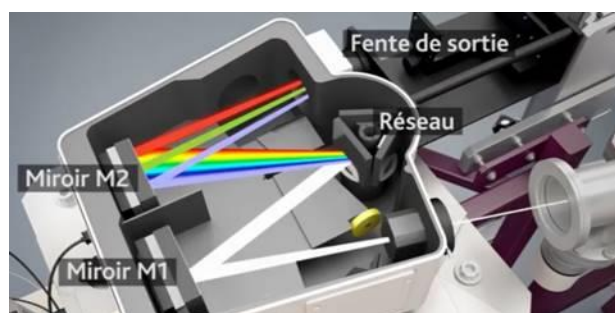
Figure 39 : Vue d'artiste du monochromateur. Image issue de la vidéo de présentation de la ligne de lumière DISCO [252]
