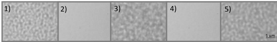
**Figure 2.40 :** Exemple de cycle d'écriture (1, 3, 5)/effacement (2, 4) réalisé sur une même zone d'un échantillon.
