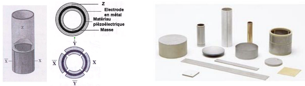
FIG. 2.14 – Tubes piézoélectriques ; exemple pour une configuration xyz ; produits commerciaux
