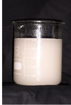
Figure 2.2-5 : Aspect d'un coulis d'hydrates de TBAB
