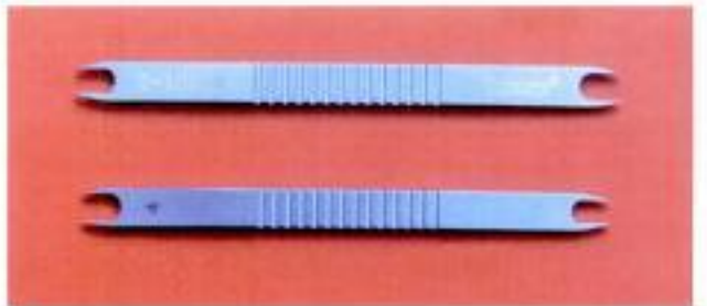
Fig. 4.56. Le compas peut être remplacé par un gabarit mesurant 3,5 mm d'un côté et 4 mm de l'autre. Ce type de gabarit tient bien en main et est moins fragile que le compas.
