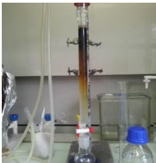
Figure 28 : Montage du fractionnement de l'extrait méthanolique de Phellodon niger
