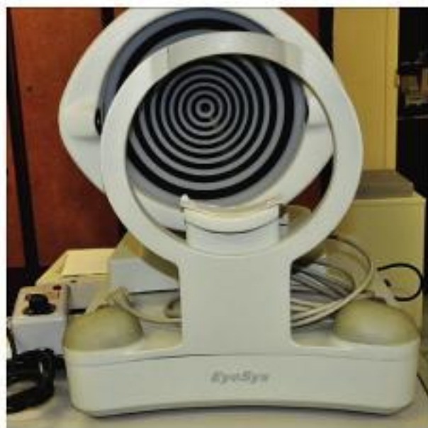
► Fig. 2.13. Vidéotopographe EyeSys. Le périphérique d'acquisition était relié à un micro-ordinateur chargé de l'importation et de l'analyse automatisée de l'image du reflet des mires de Placido.
