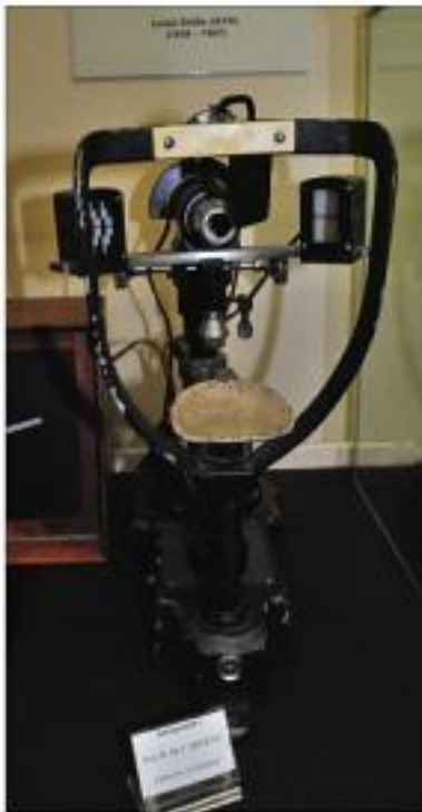
► Fig. 2.7. Kératomètre de Javal, reposant sur l'affrontement du reflet de mires graduées par le sommet de la cornée.
