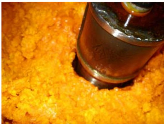
**Photo 6 : intérieur du réservoir après 199 minutes de fonctionnement du moteur et fin de l'essai car l'huile ne coule plus.**
