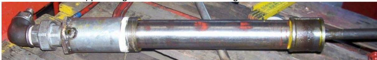
Photo 2 : échangeur de chaleur se trouvant dans le réservoir.
