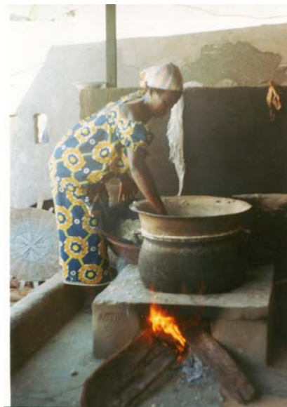
Un fourneau en béton de type ANKO (Korhogo)
