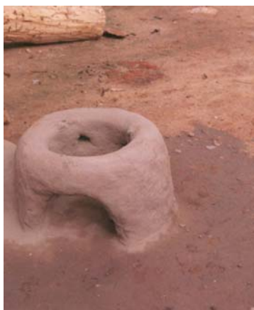
Fourneau amélioré trois pierres en terre avec une seule ouverture de cuisson (Diabo)
