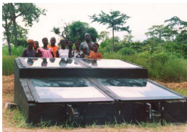
Séchoir solaire avec capteur dissocié de l'enceinte de chauffage. (Séchage de gombo à Bomizambo/Tiébissou)
