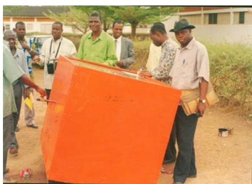
Chauffe-eau de type auto-stockeur produit localement (Grand-Bassam)
