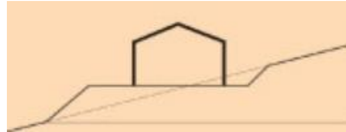
Cas usuel et inadapté : le terrain est transformé en plateforme pour poser la maison.
