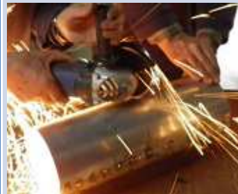
38. Découpage de la tôle du tube, en oblique à 45°, avec une scie circulaire, selon le tracé de l'outil lapidaire.
