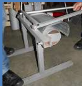
27. Suite, pliage de la tôle avec la rouleuse, en s'aidant, cette fois-ci, de 2 barres parallèles (qui permettent de tordre plus la tôle).
