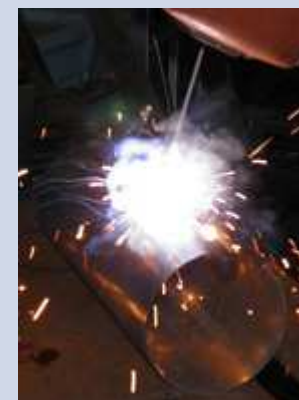
32. Soudure pour refermer le tube.
