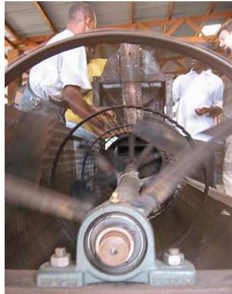
Production d'électricité à partir du biogaz
