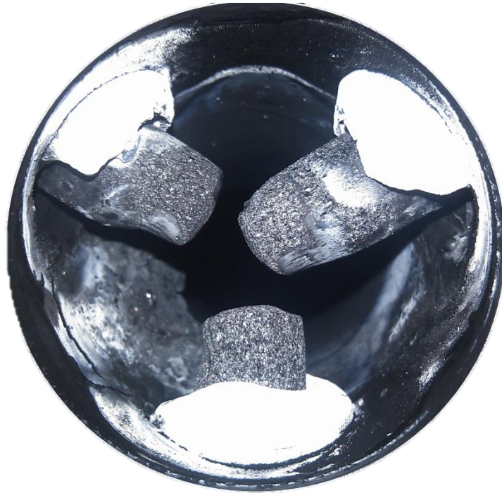
Figure 39 : Vue de dessus de la zone de décharge électrique de la torche triphasée, après un fonctionnement pendant une heure à l'air avec un débit de noir de carbone de 0,433 kg.h -1 .
