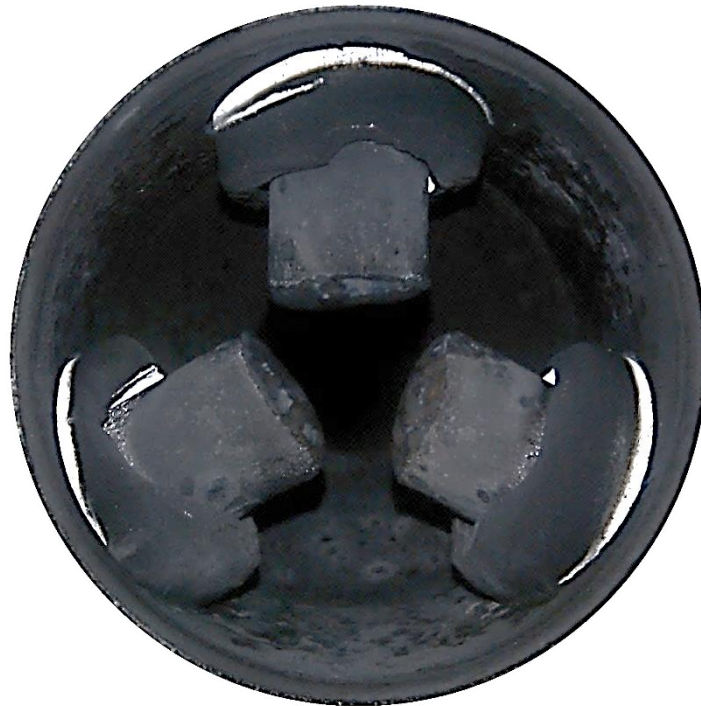
Figure 34 : Vue de dessus de la zone de décharge électrique de la torche triphasée, après un fonctionnement de 30 minutes à l'azote.
