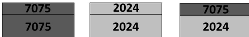
Figure V-11 : Les 3 configurations de soudage par recouvrement testées.
