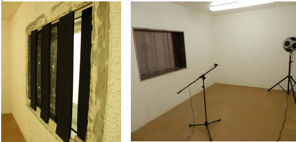
Figure 4-1. Implantation du prototype « chicanes » en mousse (gauche) et en plexiglas (droite) dans des salles réverbérantes découplées
