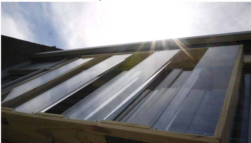
Figure 4-3. Prototype installé dans la cellule Hybcell pour mesures lumineuses
