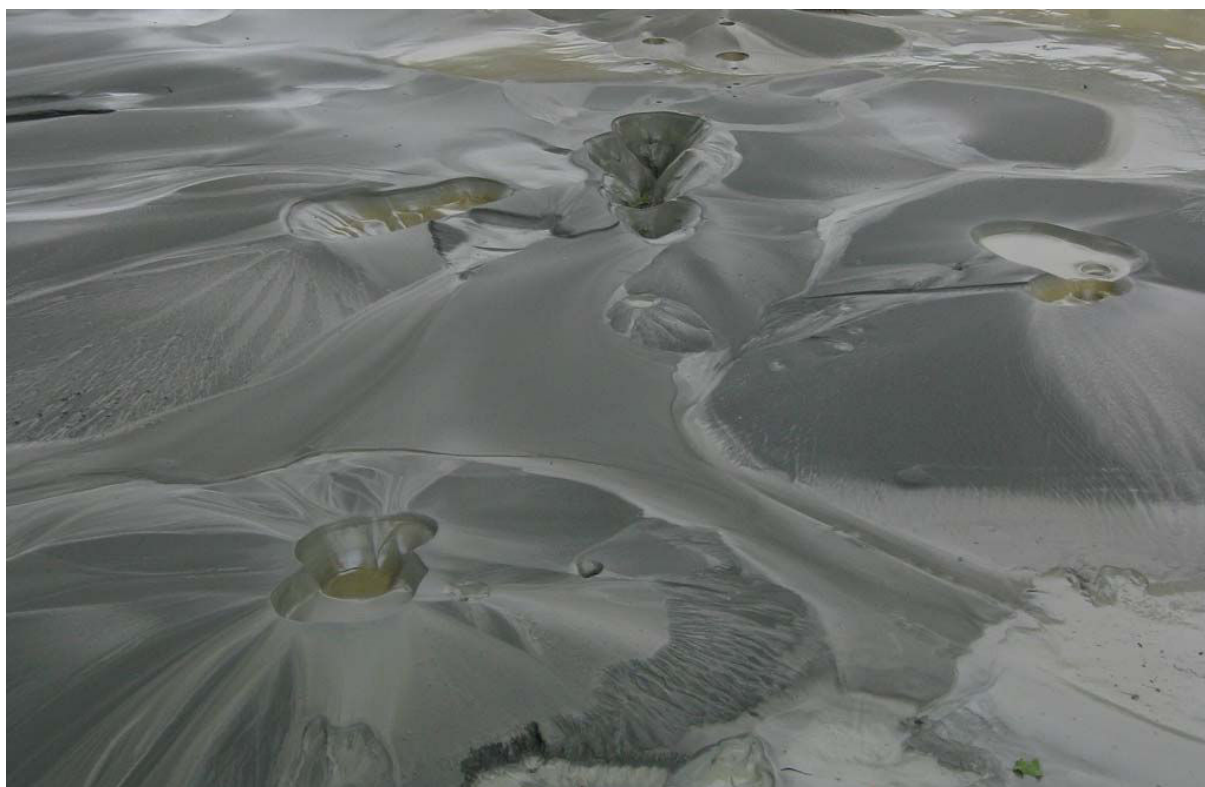
Figure 8. Phénomène de liquéfaction, avec formation de cônes de sable, causés par le séisme de Christchurch ( M_L=6.3 ) du 22 février 2011 en Nouvelle-Zélande (photo de Wikipedia)
