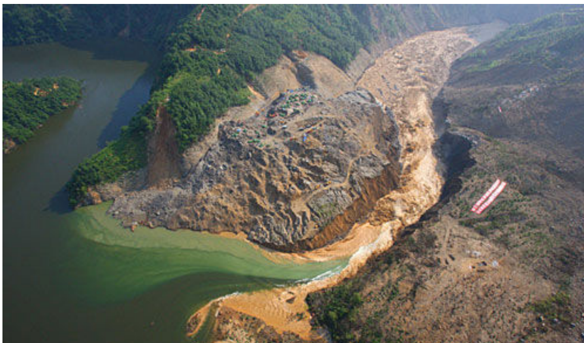
Figure 10. Le glissement de Tangjiashan sur la rivière de Jian, déclenché par le séisme de Sichuan (12-05-2008, M_w=7.9 ) a formé un lac artificiel de 240 million m^3 et a mis en danger 1.3 million d'habitants des villes de Beichuan et Mianyang en aval (Cojean et al., 2009 [49] )
