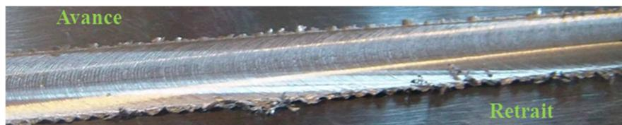
**Figure VI-7 : Soudure avec bavure pour l'essai n°29.**
