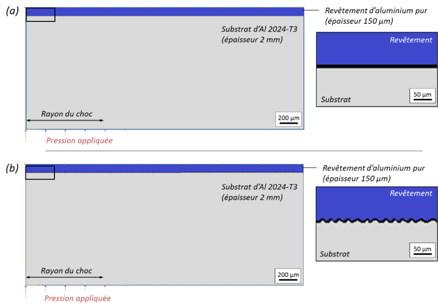
Figure 6-19: Modèles numériques 2D maillés du système revêtement d'aluminium pur 1050 sur substrat d'aluminium 2024-T3, cas d'une interface (a) plane et (b) rugueuse, utilisés pour la simulation de la propagation d'onde par choc laser.
