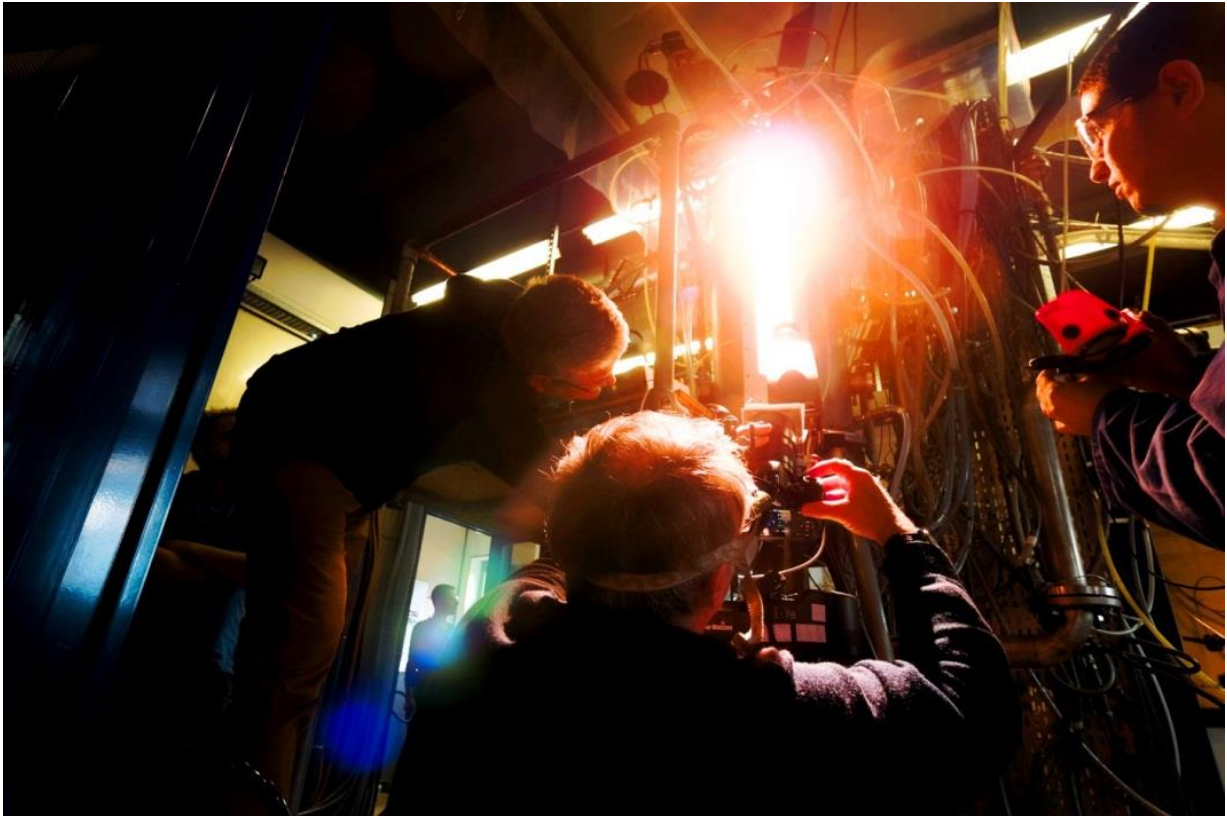
Observations de la zone réactive en cours de fonctionnement de la nouvelle torche plasma
