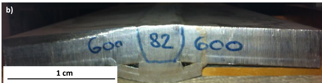
Figure 33 – Coupe dans le plan TS d’une soudure (a) représentation schématique avec indication des dimensions (en mm) et (b) image du moule D1072 étudié
