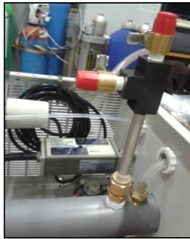
**Figure 57.** Emplacement de la Sonde de Pitot.
