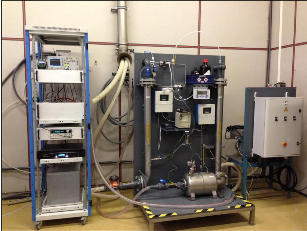
**Figure 62.** Rack contenant la pompe EHD et son alimentation électrique (à gauche) + bâti (à droite).
