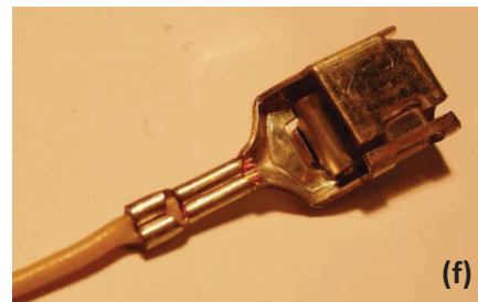
Figure 1-1 : Différentes techniques d'assemblage par déformation plastique : (a) rivetage, (b) rivetage auto poinçonneur (coupe), (c) clinchage à point rond, (d) clinchage à point carré [ROU11], (e) sertissage de tôles minces [BUI05], (f) sertissage de cosses électriques en fût ouvert.
