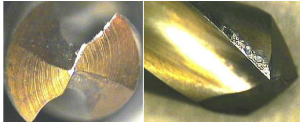
Figure 30 – Adhésion de titane, (a) sur l’arête, (b) sur les listels, après 8 trous \text{Ø}6 mm à V_c = 50 m/min et f = 0.07 mm/tr [Cant_05]
