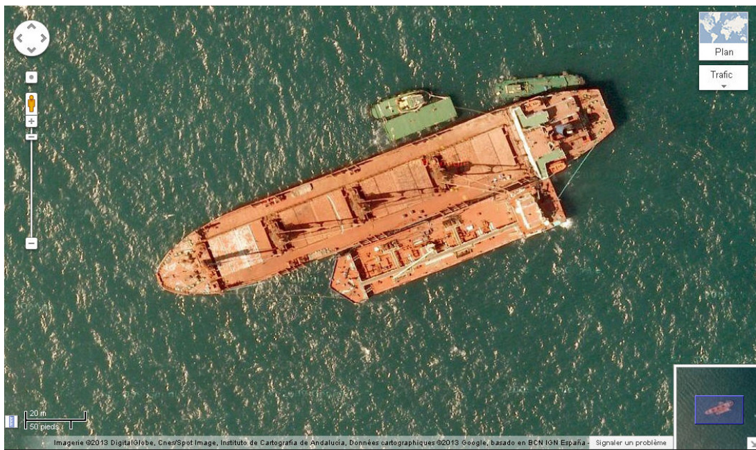
Figure 0-13 : Mise en couple de deux tankers dans un port de Gibraltar (source Google Maps)
