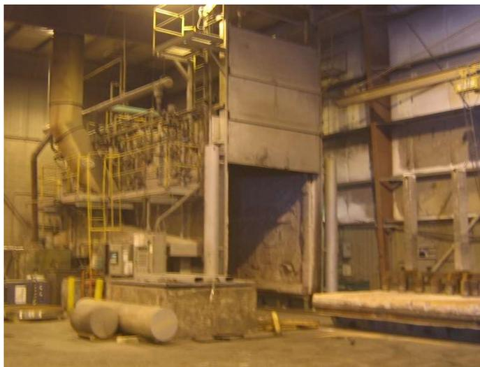
**Figure 15.** Four 30' et bac à trempe
