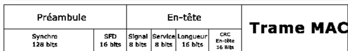
**Figure 2.11 : Structure de la trame 802.11 au niveau physique pour le DSSS**
