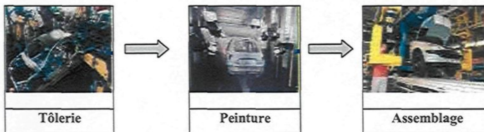
Figure 2.1 : Les trois ateliers d'une usine d'assemblage automobile [Nguyen et Cung 2005]
