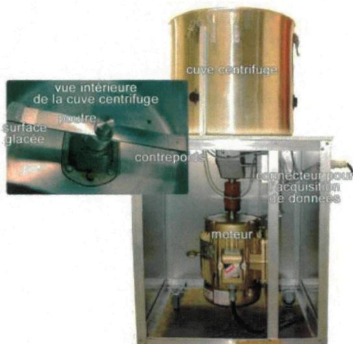
Figure 4-1 : Centrifugeuse utilisée pour la mesure d'adhérence de la glace
