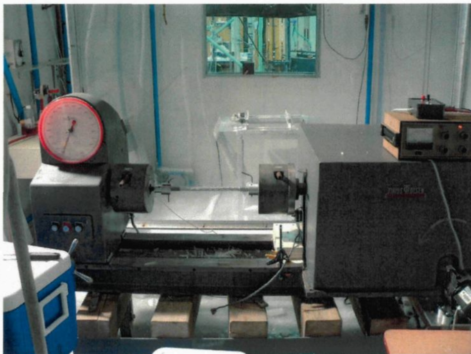
Figure 4-4 : Montage de l'essai de torsion givré
