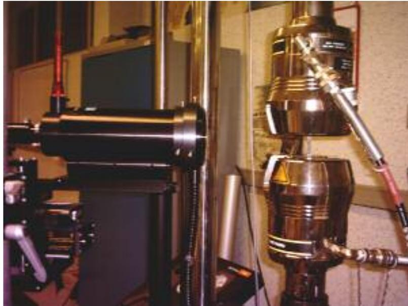
Figure V-4 : Microscope à longue distance focale
