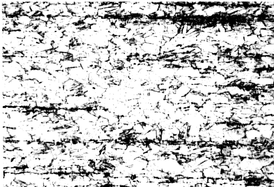
Figure 17 Microstructure en coupe longitudinale C661A avant TT (100X)
