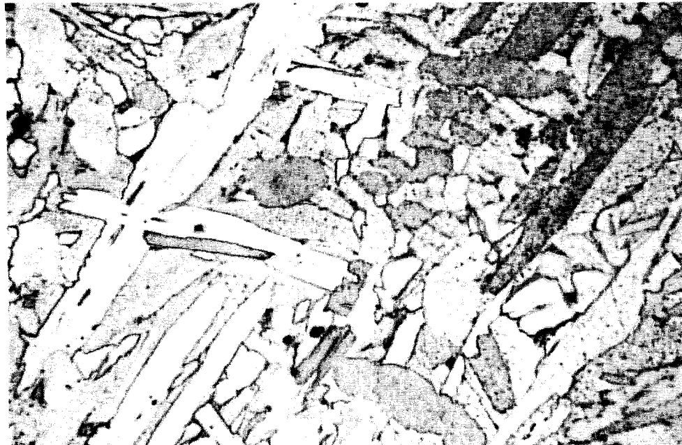
Figure 16 Microstructure en coupe longitudinale du C642 C sans TT (200X)
