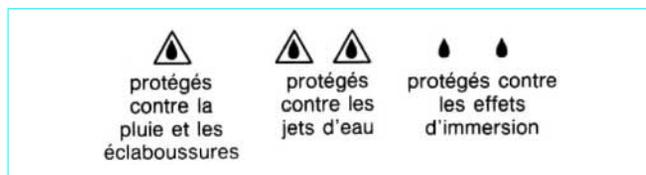
Figure 16 – Symboles utilisés pour les degrés de protection contre les agents extérieurs
