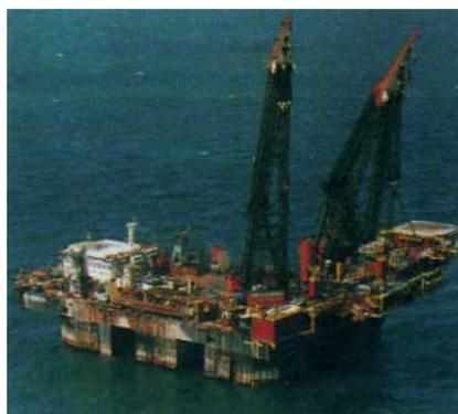
Figure 4 – Levage d'un module par une barge-grue semi-submersible (doc.Heerema)
