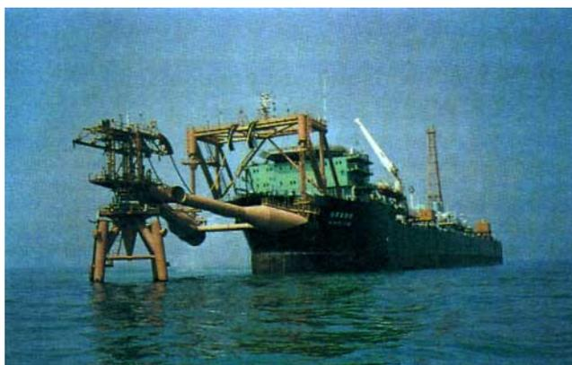
**Figure 12 – Bateau support de production flottant en baie de Bohai, Chine** (doc. Single Buoy Moorings)
