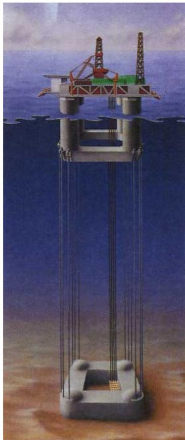
**Figure 11 – Plate-forme à ligne tendue** (Doc. Norwegian Contractors)
