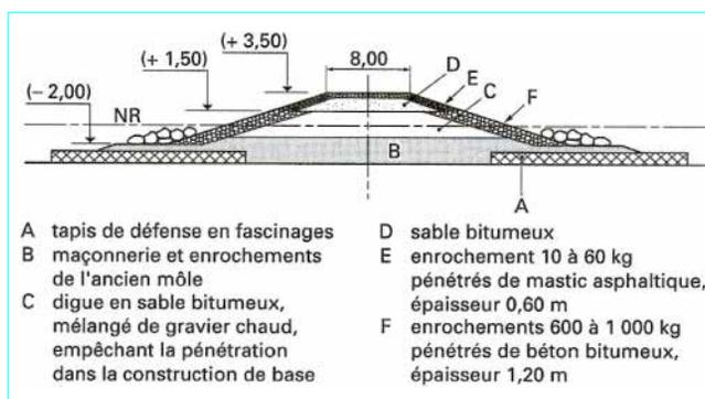
Figure 9 – Coupe type de la digue à Hock van Holland (port de Rotterdam)
