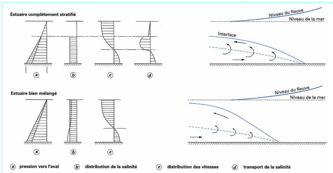
Figure 7 – Schémas de fonctionnement des estuaires
