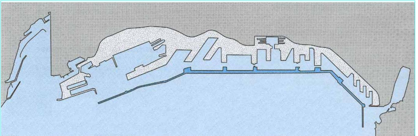
Figure 4 – Port à jetées parallèles à la côte : Marseille
