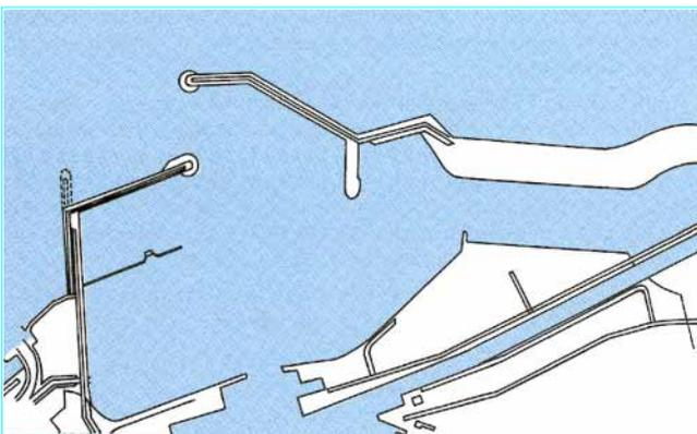
Figure 6 – Port à jetées convergentes et décalées : Dunkerque ouest
