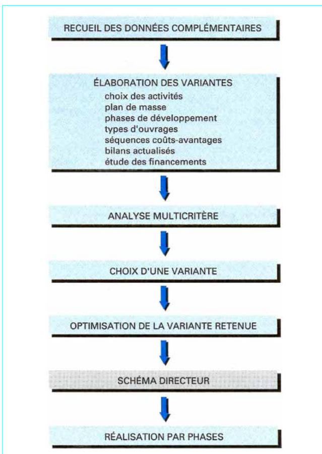
Figure 3 – Élaboration du schéma directeur du port
