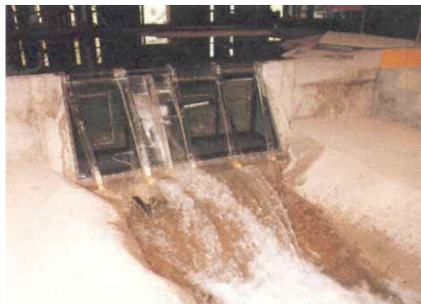
Figure 3 – Structure en plexiglas représentant l'évacuateur de crue du barrage de Serre-de-la-Fare
