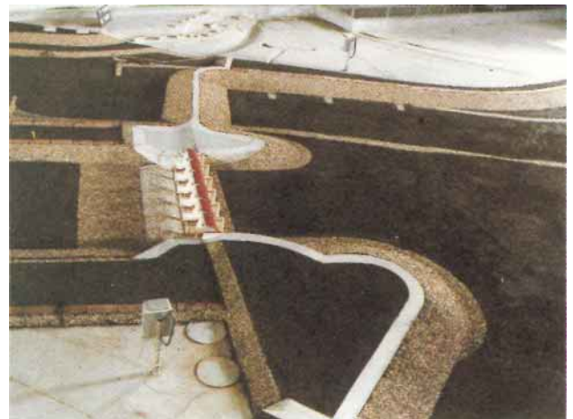
Figure 6 – Modèle physique à fonds mobiles en bakélite : aménagement de Péage-de-Roussillon
