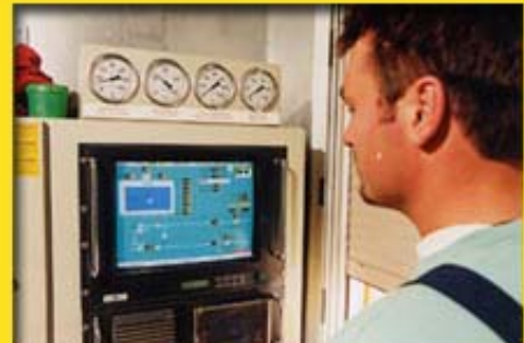
Le pilote dirige le microtunnelier
