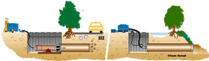
pour le fonçage non dirigé de tubes acier sous routes et voies ferrées jusqu'au DN 4000 mm, longueur maximale 80 m, entraînement: air comprimé; 13 types de machines; particularités: énorme force de frappe, très solide par sa conception (cylindre monobloc), grand champ d'application, par exemple fonçage de palplanches et de profilés.
