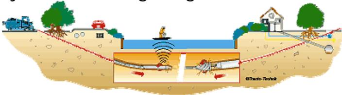
(avec marteau de percussion) pour la pose de tubes de long de routes et sous voies ferrées et rivières jusqu'au DN 600 mm, longueur maximale 500 m; entraînement: hydraulique; particularités: marteau à percussion pour des terrains rocaillieux, force de poussée et de traction max. 20 tonnes, central de malaxage pour suspension de forage, système automatique de changement de tiges, poste de commande avec siège, etc.
