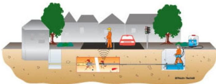
pour le branchement individuel de câbles, conduites de gaz, canalisations d'eau potable et eaux usées jusqu'à 100 mm sur des longueurs au-delà de 50 m. Sa conception compacte (longueur 1.12 m; largeur 0.47 m; hauteur 0.37 m) permet un démarrage en fouille ou en regards les plus restreints. Poids sans
