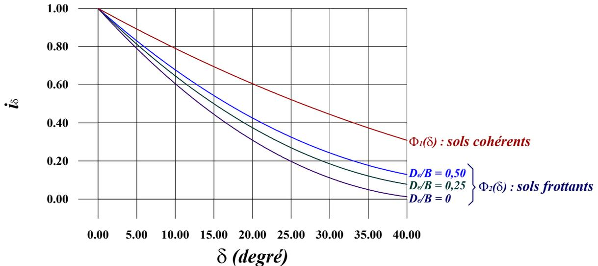
Fig.16.14 Abaque du coefficient minorateur  $i_\delta$
