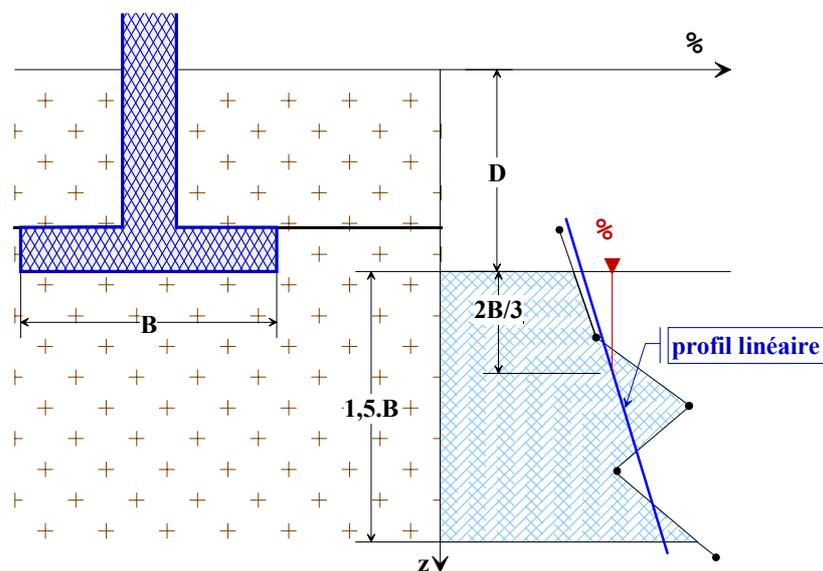
Fig.16.10 Détermination de  $p_{le}^*$  pour un terrain homogène
